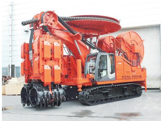
CMX-SEは掘削機本体とベースマシンで構成。機械高は5・1メートルと低空頭での施工が十分可能な設計となっている。狭い場所での施工の自由度を高めるため、ベースマシンによる旋回に加え、掘削機本体の回転角度を90度まで調整できるようにした。これにより、掘削箇所をベースマシンがまたいで掘削する「またぎ施工」を可能にした。
