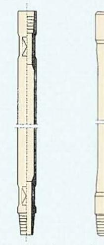
ドリルロッドについては掘削能率に大きな影響が生じるので掘削孔径、送水量、機械のトルク等を考慮にいれて選択しなければなりません。
