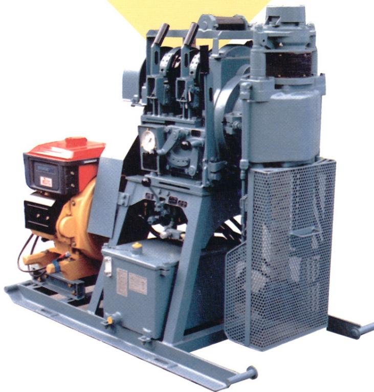
本機はダム、地這り、鉱山及び地質調査工事などに広く適応する汎用性と各種の施工条件下での操作性を重視して開発された小形汎用ボーリングマシンです。
