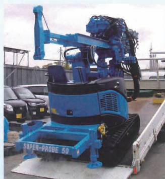
SP-50補助パワーユニット 取り外し時車載状況
