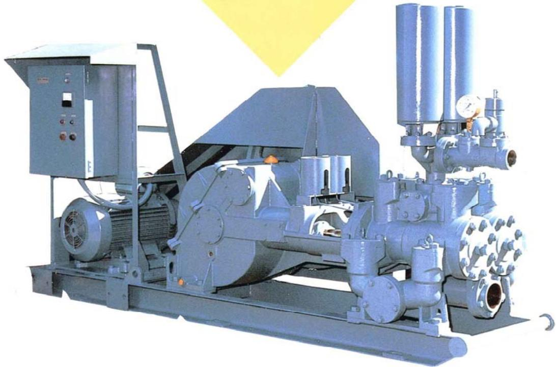
集利根多年的经验与最新的设计理念完成的多用途高性能活塞型泥浆泵。从一般的抽水，钻孔，到灌浆全部可以对应。
