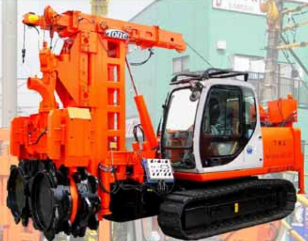
TMX 地下连续墙钻机与主机 (0.45 m 3 挖掘机)
